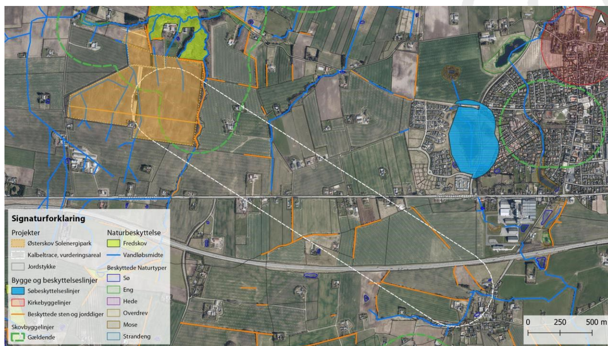
Figur 4. Mulig placering af kabeltracé inden for en 600 m bufferzone. Diger, vandløb og andre beskyttede områder er vist.
